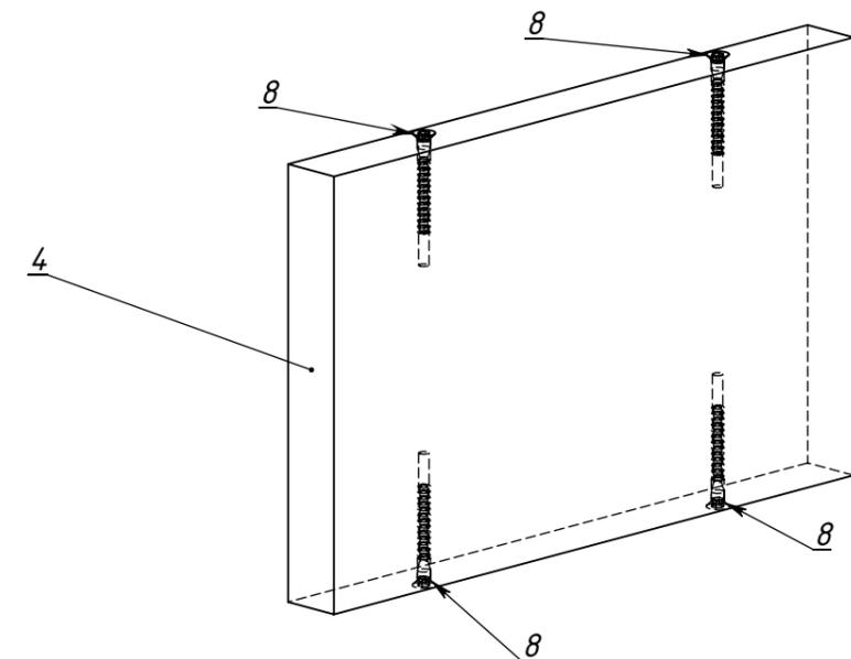
3) Совместите головки конфирматов поз. 8 в Плитах Горизонтальных поз. 3 длиной 447,5 мм с проушинами на кронштейне поз. 1 и 2.
