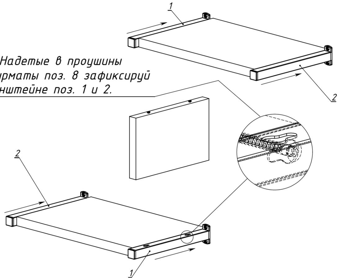
5 Совместить головки конфирматов поз. 8 на Плите Вертикальной поз. 4 длиной 175 мм с проушинами в кронштейнах поз. 1 собранных в полках из Плит Горизонтальных поз.3
