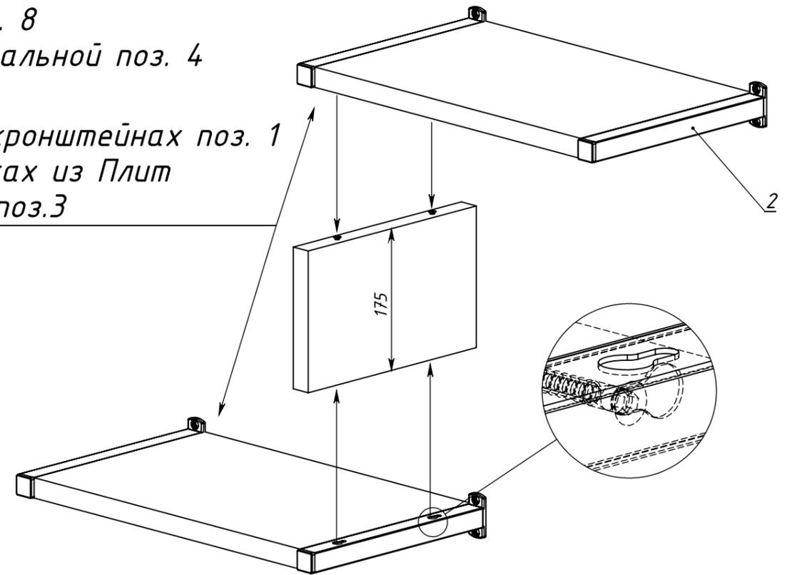
6 Надеть в проушины конфирматы поз. 8 зафиксировать в кронштейне поз. 1.
